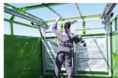
Trennwand Verzinkt auf Schienen verschiebbar
