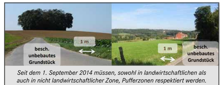
Abb. 3: Entlang der Straßengräben und beschichteten nicht bebauten Grundstücken (z.B. Straßen- und Wegnetz, Bürgersteige, Pflasterungen, Kieselsteine/Schotter, usw.), die an einem Regenwasser-Sammelnetz (z.B. Regeneinlauf, Wasserstrahl/ fließendes Wasser) angeschlossen sind auf einer Breite von 1 Meter. (Quelle: Protect'eau)
