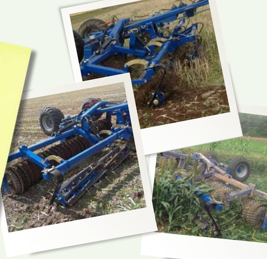
Kennen Sie schon unsere neue Prismenwalze der Firma Dalbo? Die aufgesattelte Maschine vom Typ MaxiRoll hat eine Arbeitsbreite von 8,30 m und kann durch Austausch der vorderen Werkzeuge sehr vielseitig eingesetzt werden.
