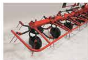
Kleine Rotordurchmesser ermöglichen eine gleichmäßigere Verteilung des Futters
