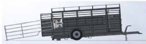
La caisse s'abaisse au sol hydrauliquement
