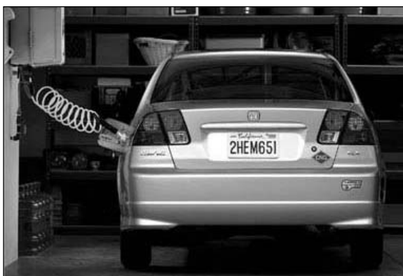
Abb. 2: Auftanken mit Bio-Methan (aus Biomasse: Biogas und/oder SNG) bzw. Erdgas zu Hause in der eigenen Garage
