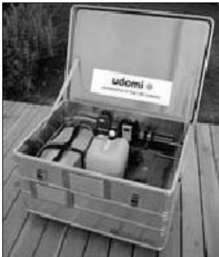
Abb.5: Stromaggregat mittels Methanol-Brennstoffzelle
